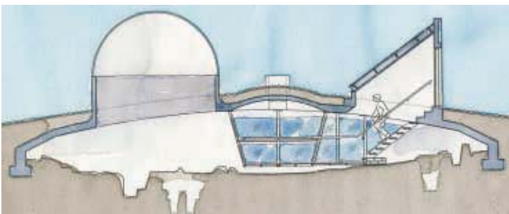
Plan- och sektionssritningar till Stjärneborg med överbyggnad från 1951 och besöksplattform från 2001.
